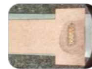
软包电池极耳 Lug laser welding
